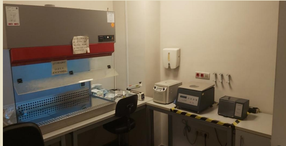
Cabina de flujo laminar; centrifuga y estufa para Endoret®
